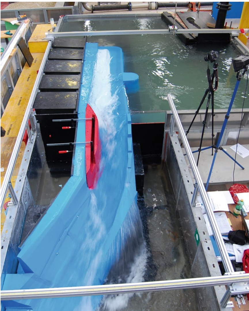
Bild 4: Laborversuch: Einbau Rampe (weiß) und Nase (rot)
