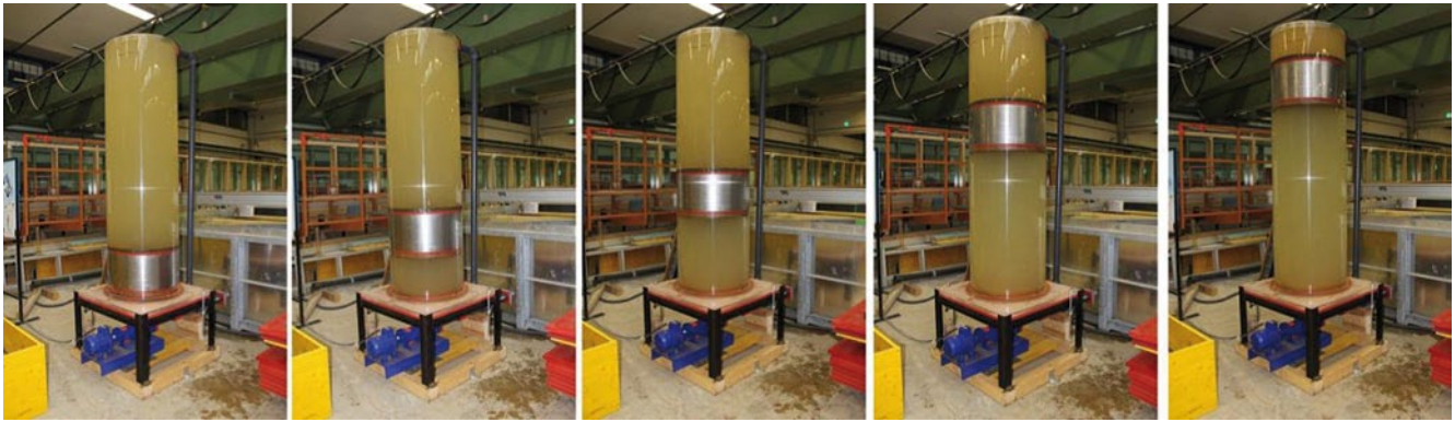
Bild 3: Prototyp des hydraulischen Großenergiespeichers Power Tower der Universität Innsbruck
