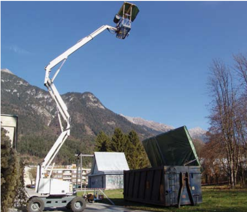
Bild 4: Laser an Hebebühne über dem Wasserbassin
