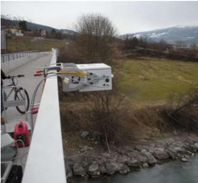
Bild 7: Befestigung des Lasersystems an einer Innbrücke
