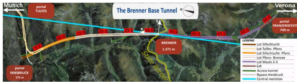
Abbildung 3: Plan des BBT-Projektstandortes, auf dem die Topographie, die Staatsgrenze Österreich-Italien, die Tunnelachsen zusammen mit dem Mittelmeridian, dem Koordinatenursprung und die -achsen dargestellt sind.
