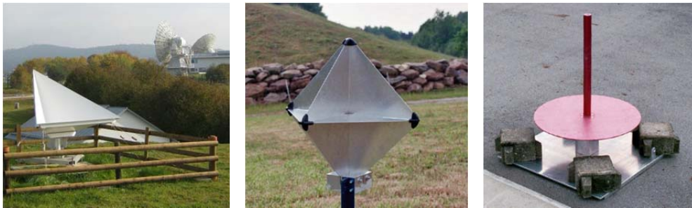
Abb. 2: Beispiele für Reflektoren, welche künstliche reflektierte Radarsignale erzeugen die von TerraSAR-X bzw. TanDEM-X im „Spotlight Image“ Modus identifiziert werden können: Links: Tripel-Spiegel, Mitte: kleiner Oktaeder, Rechts: Zylinder
