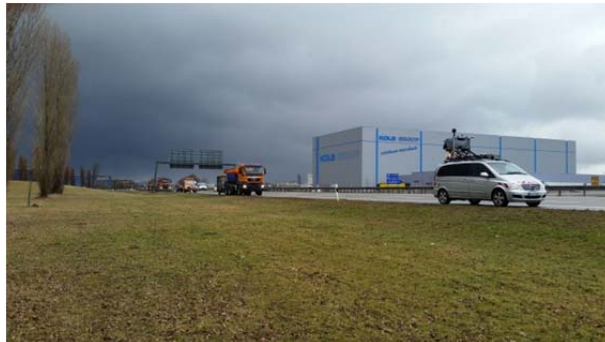
Abb. 8: MX8 im Einsatz vor Sicherungsfahrzeug-Kolonne
