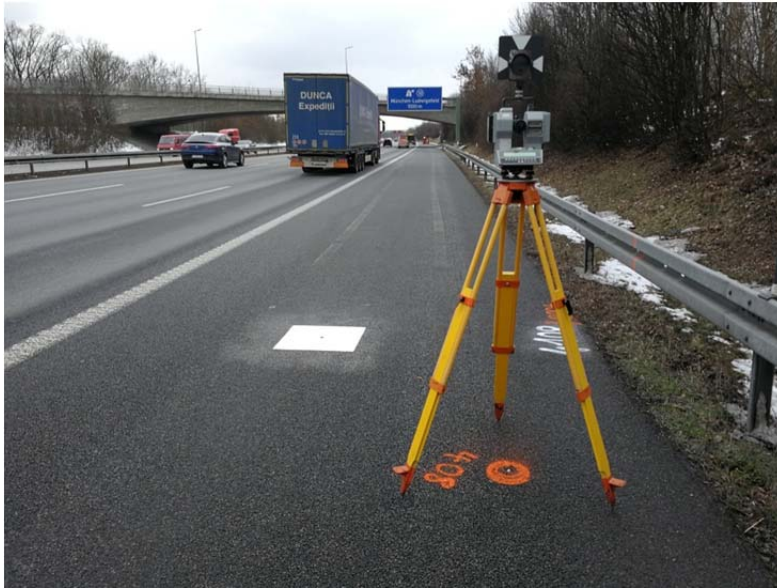
Abb. 11: Tachymeter RegElta2 mit Zieleinrichtung zur gegenseitig gleichzeitigen Anmessung
