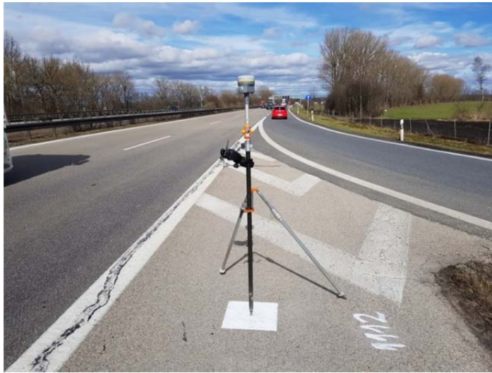
Abb. 9: Passpunkt mit GNNS-Messanordnung mit Reflektor
