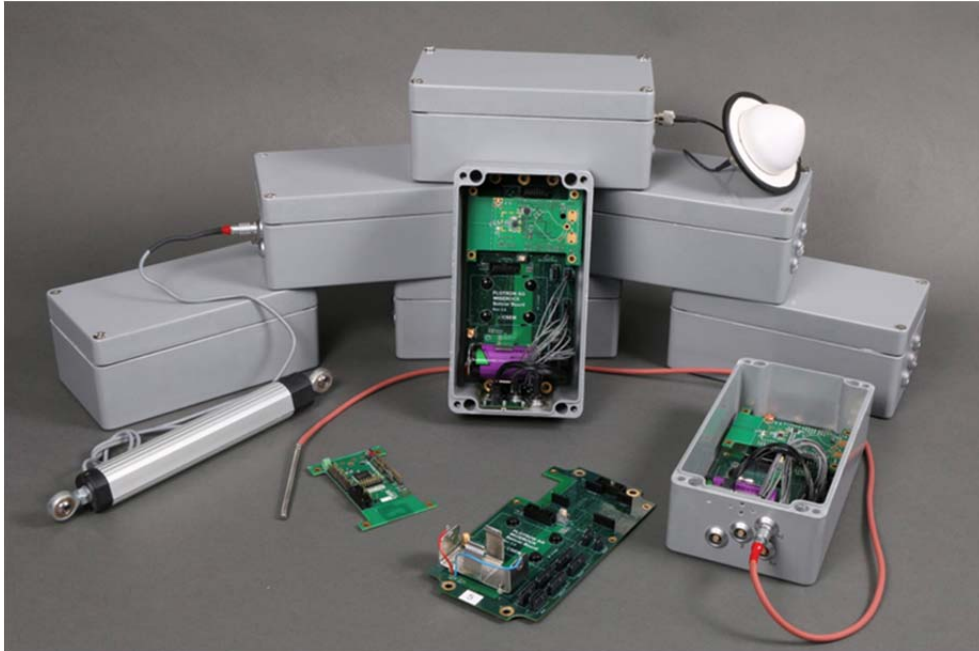
Abb. 1: Prototypen der Sensorknoten mit diversen externen Sensoren
