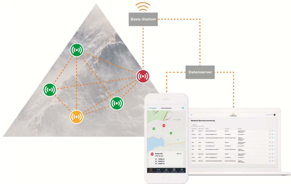
Abb. 2: Komponenten von Wiserock und Kommunikationswege
