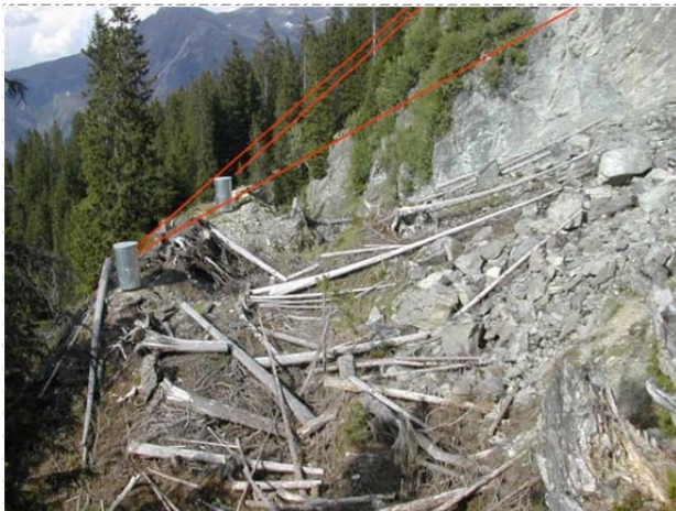
Abb. 8: Seilextensometer mit rot nachgezeichneten Seilen, auf der Oberkante des Felskopfes
