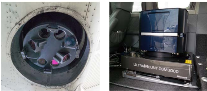
Abb. 1: UltraCam Osprey Mark 2 Sensorkopf von unten (links), Kamerasystem und Kreiselstabilisierung innerhalb des Flugzeugs (rechts).
