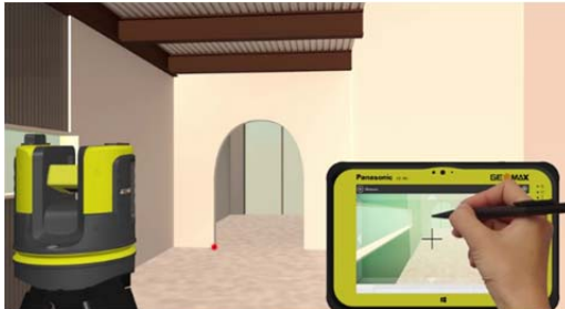
Abb. 3: Aufmaß über die integrierte Kamera
