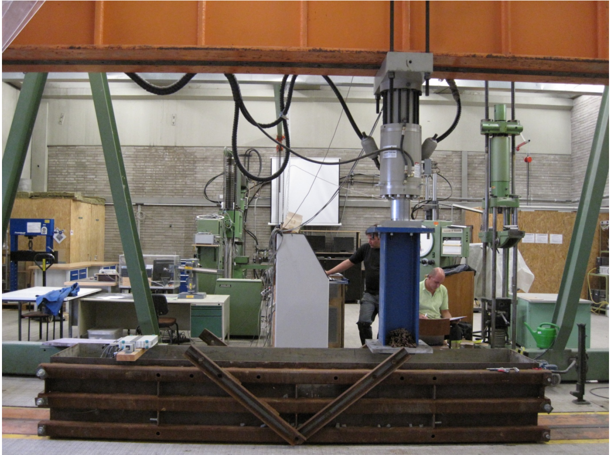
Versuchsdurchführung – Hydropulsanlage mit Schotterkasten in der TVFA der Universität Innsbruck
