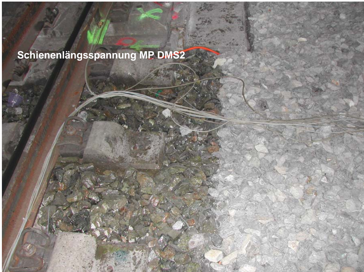
Beispiel: Übergang Rhedaoberbau – verfestigter Schotteroberbau
