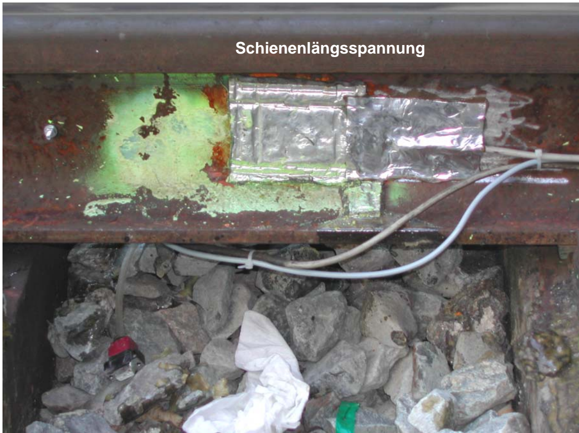
Beispiel: Messung der Schienenlängsspannungen mit DMS-Vollbrücke
