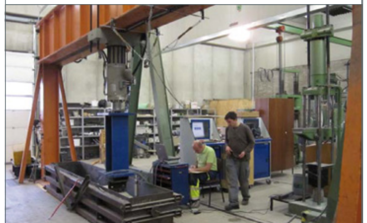
BILD 2: Hydropulsanlage der Technischen Versuchs- und Forschungsanstalt der Universität Innsbruck (TVFA)
