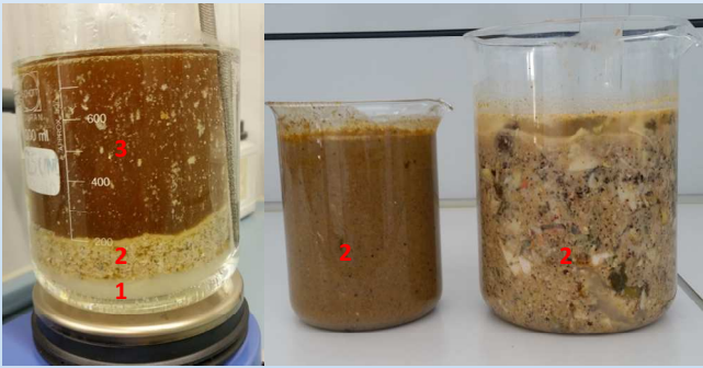
Abb. 1: Gewinnung von Öl bei 60°C. Links: Auftrennung in wässrige Phase (1), Speisereste (2) und Öl-Phase (3). Mitte, Rechts: Schwimmschicht aus Speiseresten, komplettes Fehlen der Öl-Phase.
