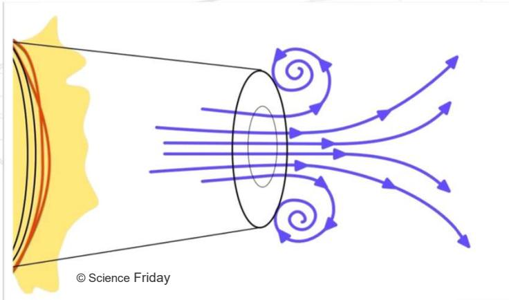
Eine Vortex-Kanone funktioniert in erster Linie dadurch, dass sie schnell und effizient Kraft auf Luftmoleküle in einem halbgeschlossenen Raum ausübt.
