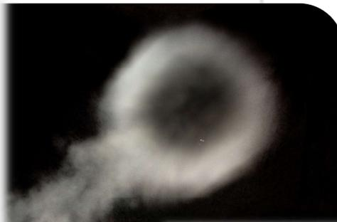
Die einzige Möglichkeit für alle kollidierenden Luftmoleküle zu entkommen ist, durch die Öffnung am Ende des Rohrs. Das schnelle Entweichen der Luftmoleküle bildet einen Luftstrom oder Strahl, der direkt aus der Kanone strömt.
