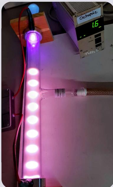
In der **Plasma-Röhre** wird eine Hochspannung im Kilovolt-Bereich zwischen Anode (im Bild unten) und Kathode (oben) angelegt. Wenn der Druck durch die Vakuum Pumpe tief genug ist, bewegen sich die Elektronen ohne Widerstand entlang des elektrischen Feldes durch die Röhre. Stoßen sie doch mit einem der Restgasmoleküle, werden diese angeregt oder ionisiert. Bei der Abregung wird die Energie in Form von Licht wieder frei.
