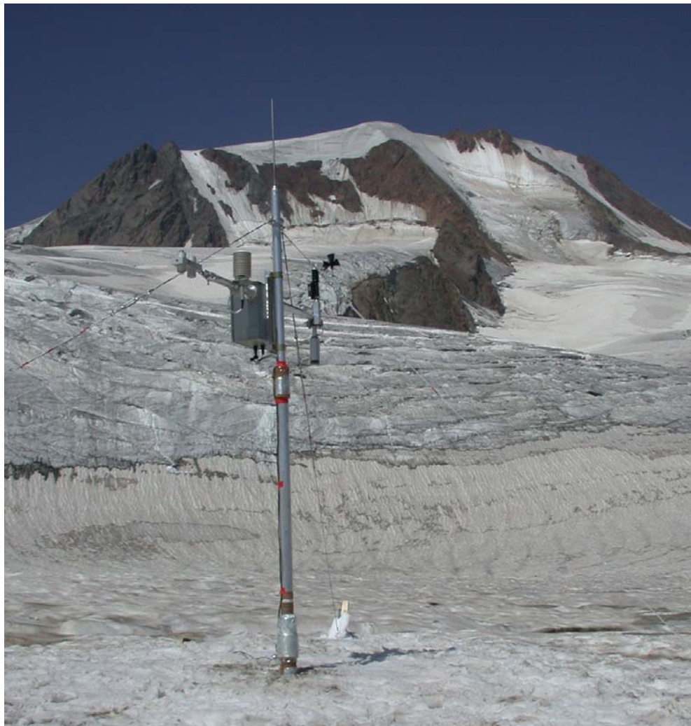
Abbildung 5.2: Die Station Teufelsegg am Tag des Aufstellens gegen die Weißkugel; Auf dem linken Ausleger befinden sich beide Pyrano- und Pyrgeometer und der Young'sche Strahlungsschutz für den Temperatur- und Feuchtemesser. Auf dem rechten Ausleger sind der Ultraschallsensor und das Anemometer zu erkennen. In der Mitte befindet sich der Schaltkasten mit der Datenerfassung und der Batterie. Auf dieser Richtung Osten schauenden Seite des Gletschers befinden sich mehrere Geländekanten, welche von flachen Stellen getrennt sind.
