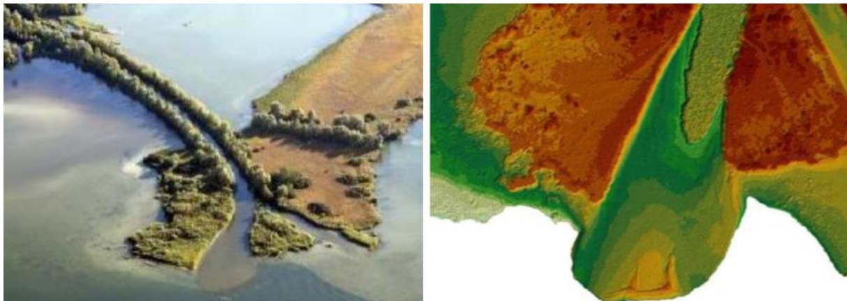
Abbildung 5: Flussdelta – Datenerhebung mit Airborne Hydromapping ohne direkten Zugang in das geschützte Ökosystem (links: Foto, rechts: AHM-Höhenprofil)
