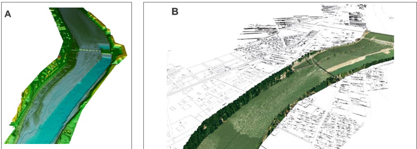
Bild 8: a) Digitales, trianguliertes Geländemodell nach der Höhe eingefärbt, Blick gegen die Fließrichtung. Zellengröße 1 m; b) Luftbilder auf Punktwolke (Orthophoto vor der Umsetzung der neuen Kraftwerksanlage als Vergleichsgrundlage) sowie zusätzliche Informationen aus der digitalen Flurkarte
