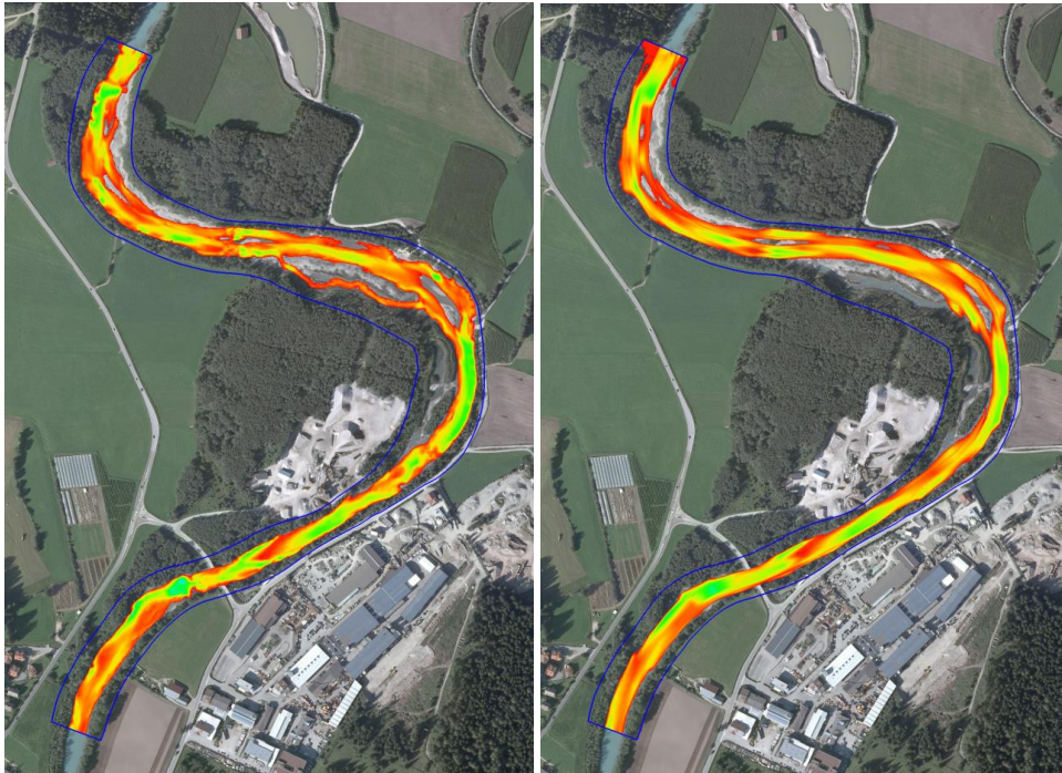
Abb. 18: Darstellung der berechneten Wassertiefen bei einem Abfluss von 12 \text{ m}^3/\text{s} : Ergebnisse für 1 \times 1 \text{ m} Raster basierend auf den Grundpunkten aus den Hydromapping-Daten (links) und interpoliertem Netz zwischen Querprofilen (rechts) /aus Jocham et al. 2014/.
