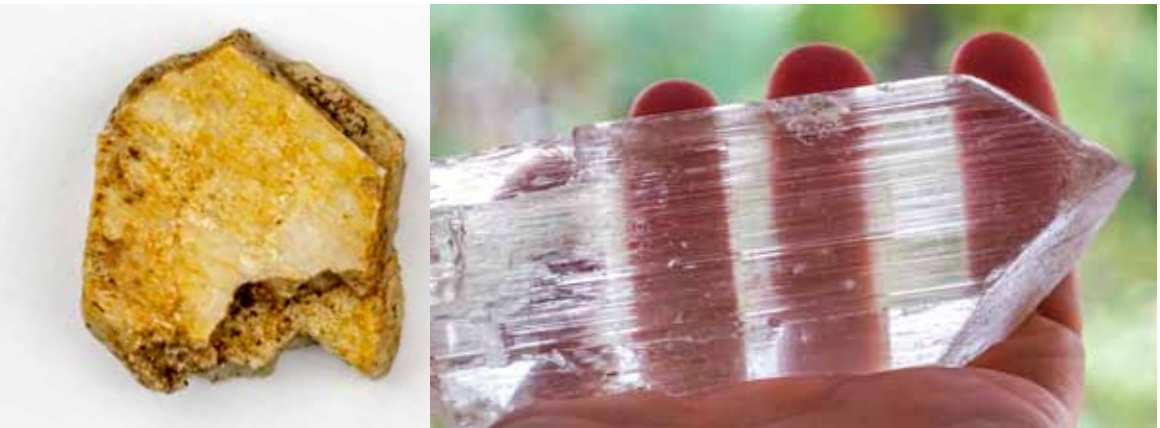
Abb.5: Grade der Opazität in Spodumen: ein undurchsichtiges Exemplar aus der Steiermark (links, ca. 4 cm lang) und ein völlig transparentes aus Afghanistan (rechts, ca. 14 cm lang) markieren die Extreme.
