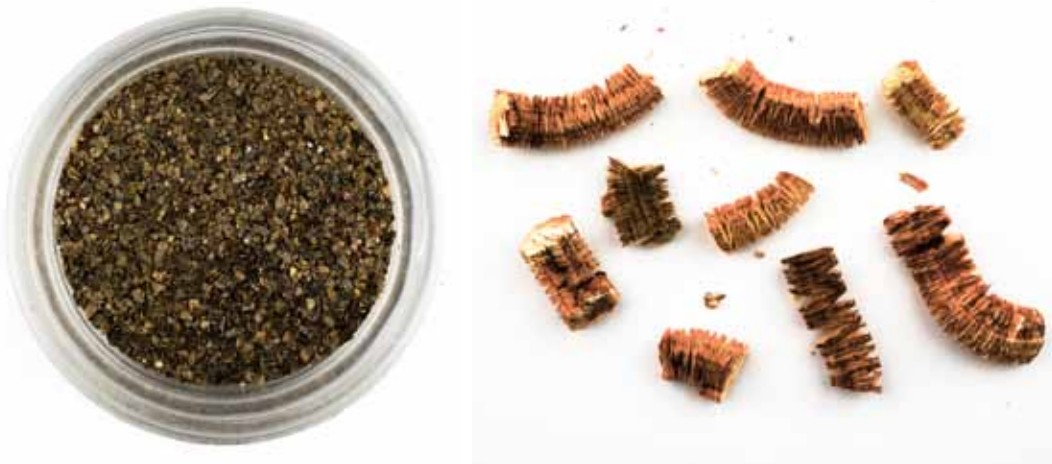
Abb.1: Das linke Foto von kommerziell abgebautem Vermiculit aus China zeigt blättchenförmige Kristalle, in deren Form das Mineral typischerweise gefunden und gefördert wird (Durchmesser der Blättchen ca. 1 mm). Das rechte Bild zeigt einen stark erhitzten Vermiculitkristall aus Waldkirchen (Waldviertel, Niederösterreich – vgl. GÖTZINGER, 1987), der die charakteristische und namensgebende Eigenschaft veranschaulicht, bei derartiger Behandlung ziehharmonikaartig auf ein Vielfaches des Volumens zu „Würmchen“ zu expandieren (das längste abgebildete Aggregat ist 2.3 cm lang).
