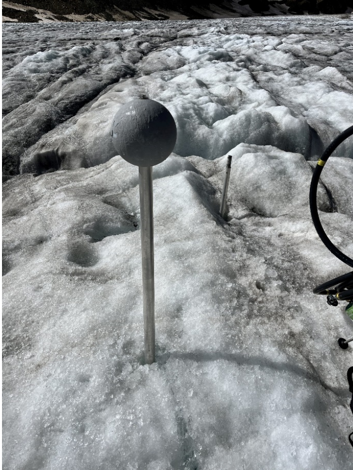
Abbildung 19: Der neu gebohrte Pegel L5 (LIDAR), oder auch "Lollipop" genannt. Foto: Lindsey Nicholson 08.08.2024
