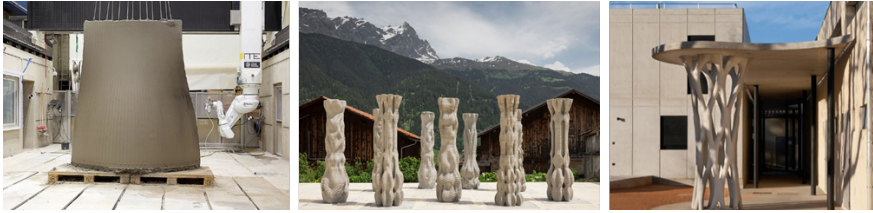
Abb. 4-2: v. l. n. r.: Doppelt-gekrümmte Stahlbeton basierend auf dem SC3DP-Verfahren [26], Mitte: Individualisierte Betonstützen hergestellt mittels Partikelbett-Verfahren [27], Betonstütze hergestellt mittels Extrusion-Verfahren in Fachwerk-Form [28].
