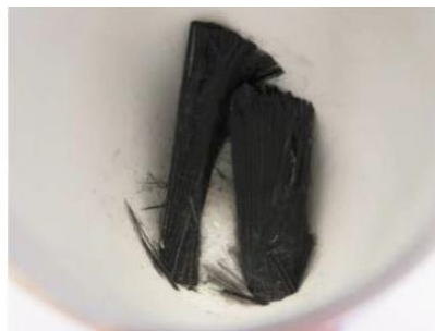
Abb. 2-1: Carbonfasern vor und nach der Pyrolyse bei 550°C (ITM, TU Dresden)
