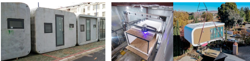
Abb. 4-4: v. l. n. r.: Vorgefertigte Quarantäne-Zellen von WinSun zur Ergänzung von Krankenhäusern mittels Extrusion-Verfahren auf Zementbasis [32] sowie Raumzellen von Mighty Buildings Extrusionsverfahren allerdings auf Basis von photopolymerem Material, das durch UV-Licht aushärtet [33].
