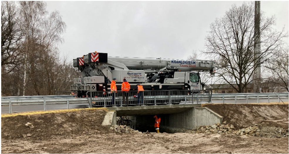
Abb. 2.5: Belastungsprobe der Brücke an der S111 [CARBOCON GMBH, P. Riegelmann]
