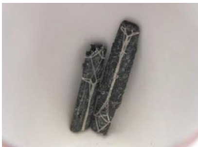
Abb. 2-1: Carbonfasern vor und nach der Pyrolyse bei 550°C (ITM, TU Dresden)
