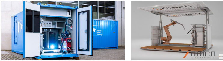
Abb. 4-5: Mobile Smart Factory (links) für additiven Fertigung von Metall- und Kunststoffteilen [34] und Odico Formwork Robotics (rechts) zur subtraktiven Fertigung von Schalungselementen [35].
