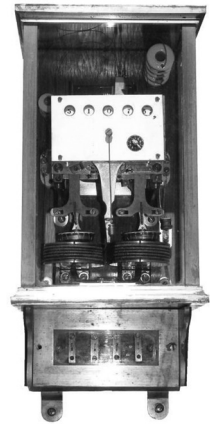
Abb. 4: Pendelzähler nach Aron
