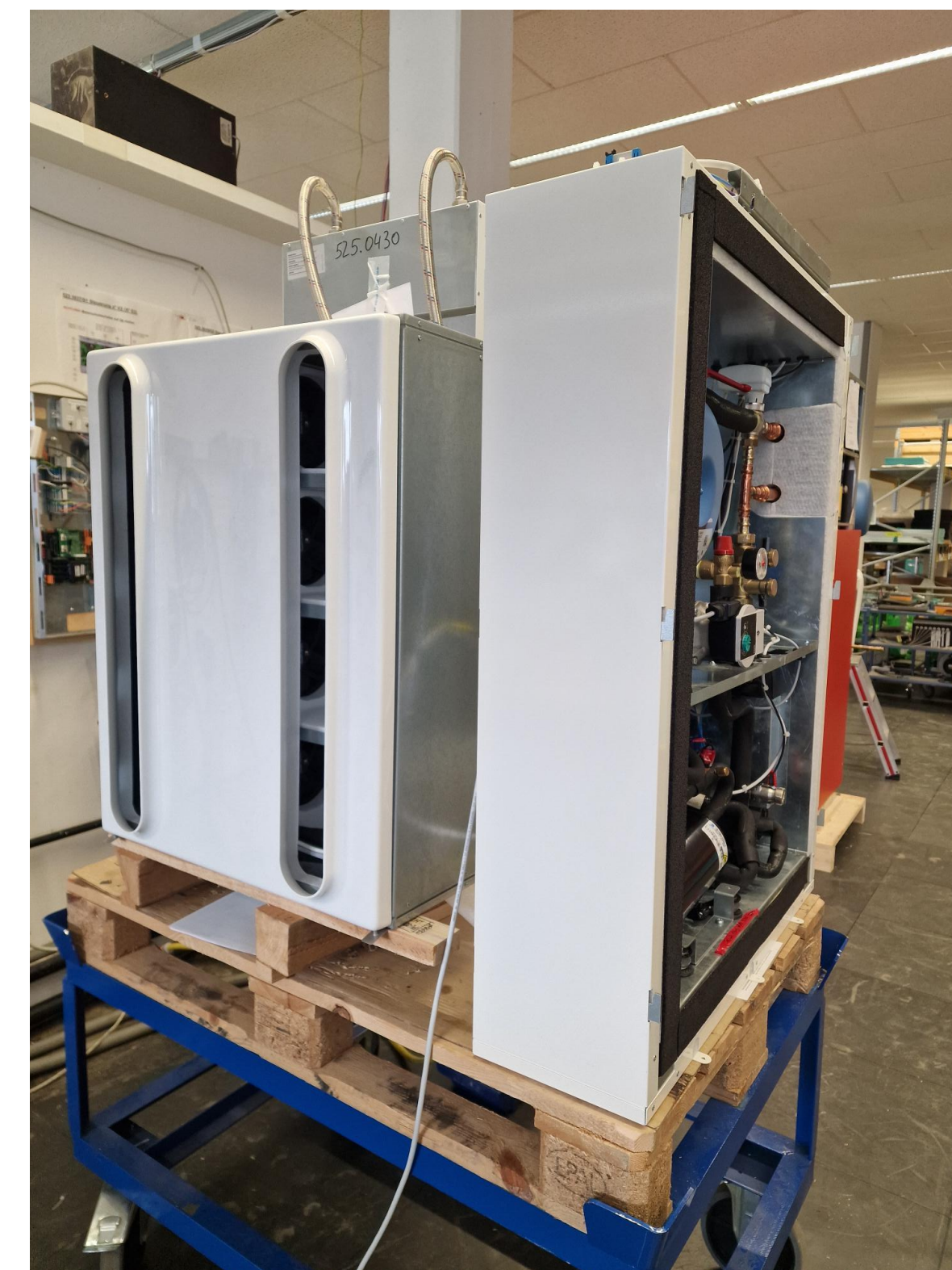
Außenteil der WW-Wärmepumpe (mit Kunststofffront, ohne Lamellen aus 3D-Druck)
