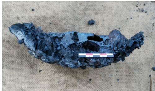
Abb. 6: Nach dem Abheben von Plattenschlacke im Ofen erstarrte Kalotte aus Schlacke und Kupferstein.
