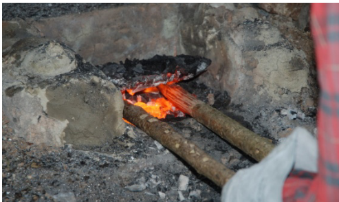
Abb. 5: Abheben einer tellerförmigen Plattenschlacke von der Restschmelze.
