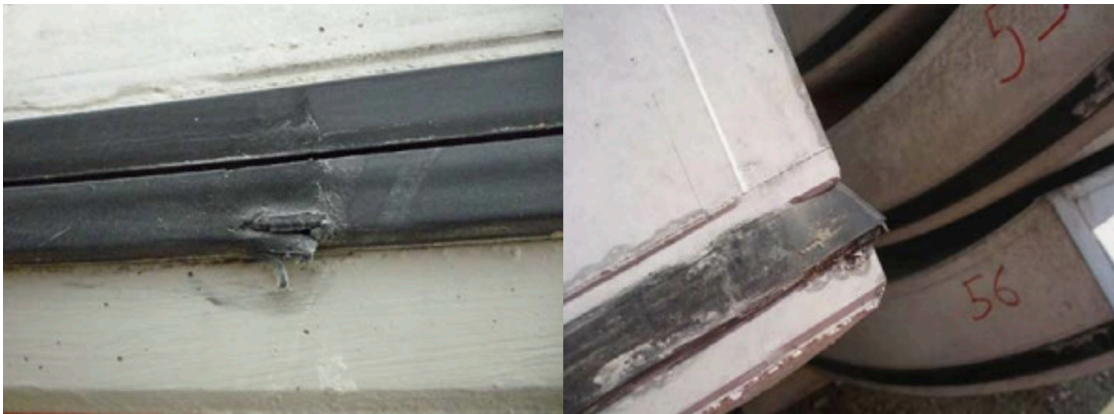
Abbildung 2-24: Beispiel für beschädigte Dichtungsrahmen [9]
