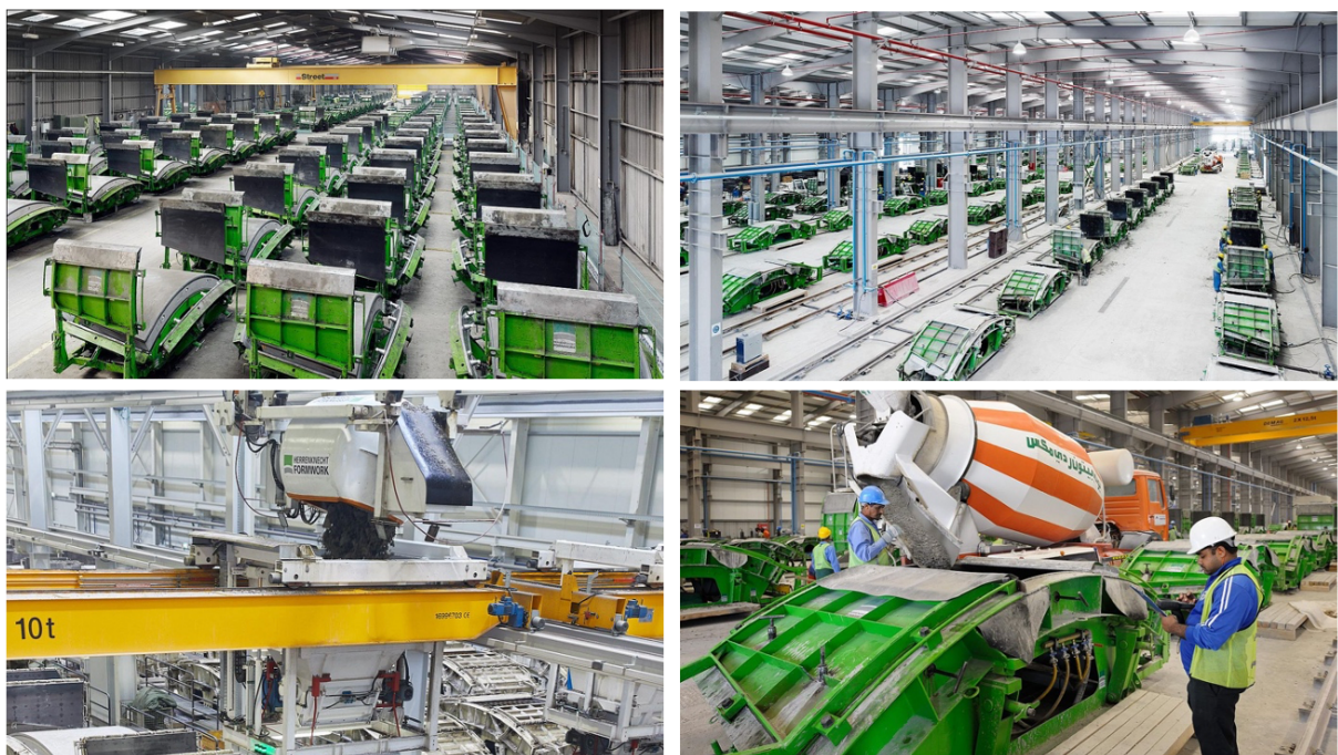
Abbildung 2-14: Standfertigung mit Kübel (links) und mit Fahrmischer (rechts) [29]
