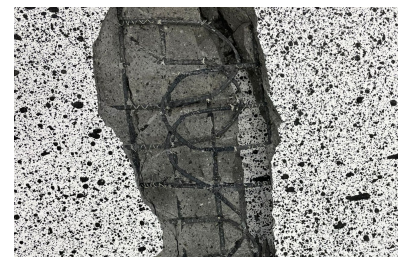
Abbildung 2: 3P-Biegeversuch – Freigelegter Soutache-Stoß im Probekörper nach Versagen
