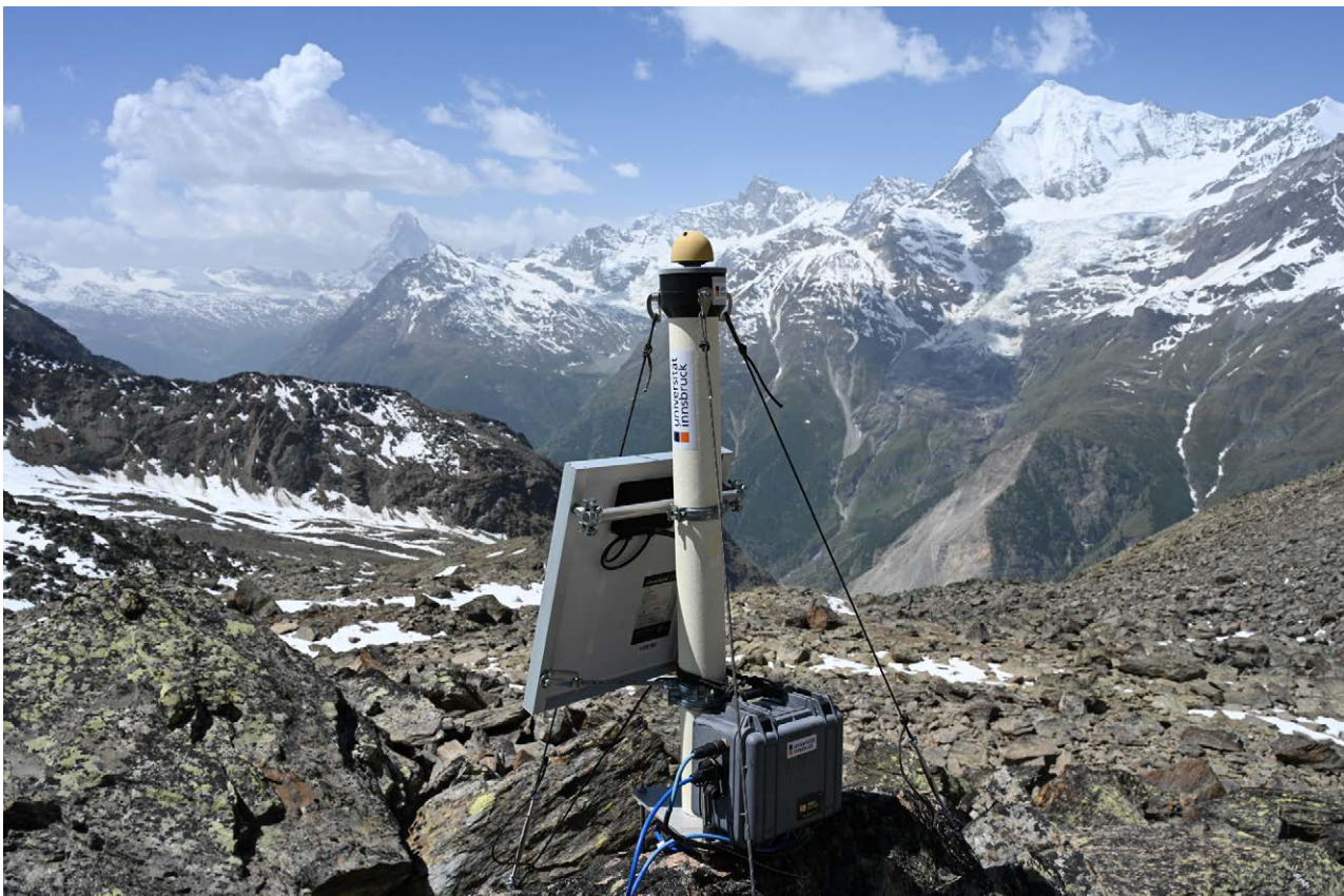
Messanordnung des Networked Embedded Sensing Center (Institut für Informatik) am Dirrugletscher in der Mischabelgruppe der Walliser Alpen (Schweiz). Im Hintergrund die Gipfel und Gletscher zwischen Matterhorn und Weisshorn.
