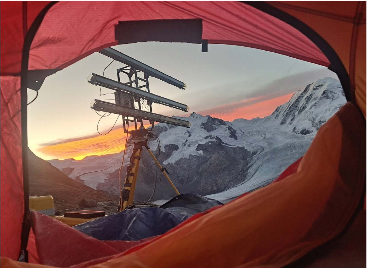
Morgendlicher Blick aus dem Zelt auf ein Radarinterferometer zur Messung der Fließgeschwindigkeit des Grenzgletschers in der Monte Rosa Gruppe (Walliser Alpen, Schweiz).
