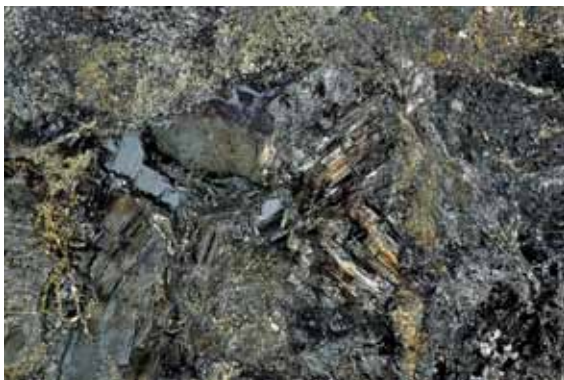
Abb. 66 Aramayoit in cm-großen Einschlüssen mit charakteristischer Spaltbarkeit in Freibergit-Pyrit-Erz. Das Probenmaterial stammt von W. Vaux, der die Stücke bei seinen Expeditionen (1929-1930) in Chocaya (Grube Animas) gesammelt hatte.
