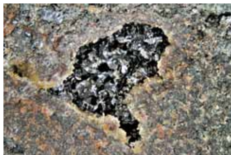
Abb. 22 Teallit in folienartigen, stark deformierten Kristallen in einem Drusenraum (4 cm) in silifizierter Matrix. Rampe im Oplocasektor, Sohle 10, Pirquitas.
