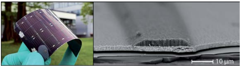
Links: Flexible Dünnschichtsolarzelle Solarzellen, hergestellt im Zuge des Projektes NoFrontiers; Rechts: Elektronenmikroskop Aufnahme des Schichtaufbaus der Solarzelle (im Querschnitt).
