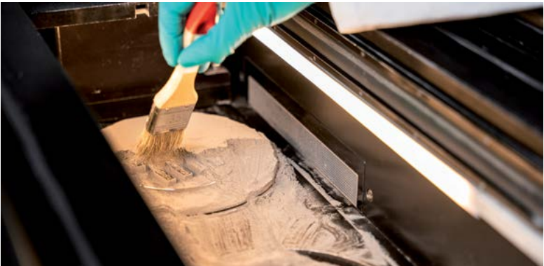
Blick in eine Laser Powder Bed Fusion Anlage am Ende des Fertigigungsprozesses. In dieser Anlage wird Metallpulver mit Hilfe eines Hochleistungslasers in einem schichtweisen Aufbauprozess zu Bauteilen verschmolzen.
