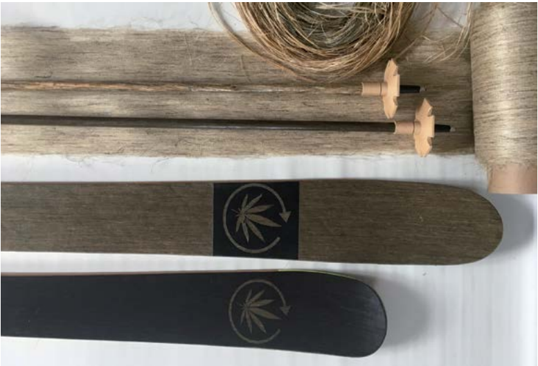
Untersuchung der Eignung von Hanf als textile Verstärkung im Ski.
