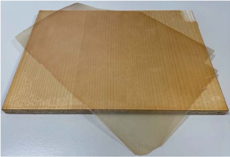
Ein gezielt von einem Holzsubstrat abgelöster Lackfilm. Mit den von uns entwickelten Lacksystemen ist ein rückstandsloses Ablösen der Beschichtung vom Untergrund jederzeit möglich.
