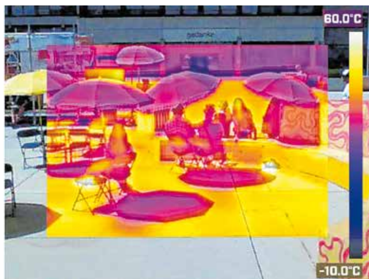
Thermografische Aufnahmen zeigen mit einem Farbspektrum Oberflächentemperaturen auf.
