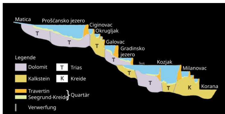
Abbildung 33: Hydrogeologisches Profil der Plitvicer Seen.
