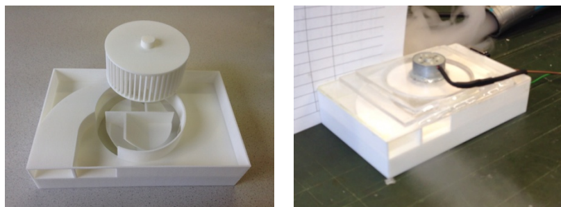
Abbildung 19: Miniatur-Funktionsmuster mittels 3D-Druckverfahren (links) und Rauchgasversuch des zusammengesetzten Systems (rechts). (Speer, 2014)
