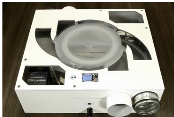
Abbildung 26: Maßstabsgetreues Funktionsmuster des CHRf mit symmetrischer Strömungsführung und implementierten mechatronischen Komponenten. (Speer et al., 2015)
