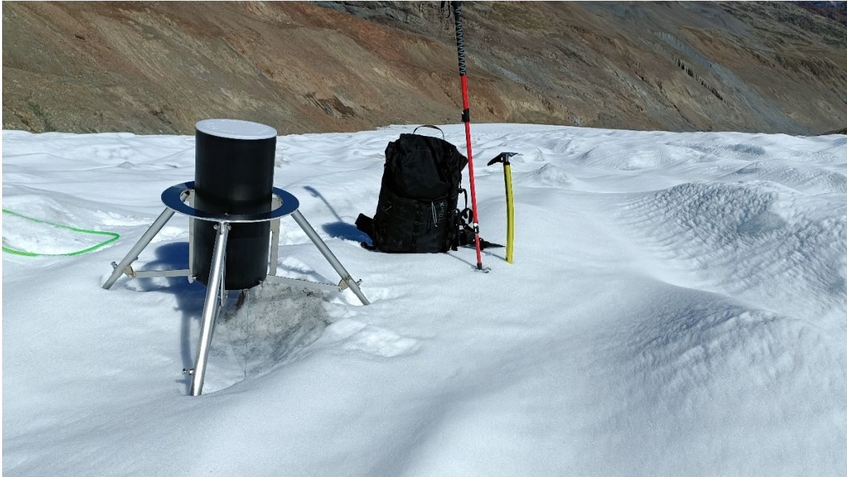
Abbildung 23: Der SmartStake am Hintereisferner misst automatisch die Ablation über das Aufwickeln einer ins Eis eingebrachte Schnur, die durch Ablation freigegeben wird. Foto: Rainer Prinz, 27.09.2023.
