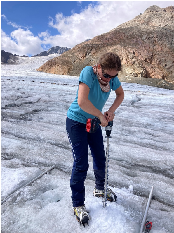
Abbildung 21: Bohren von Ablationspegeln. Foto: Lindsey Nicholson 18.08.2023
