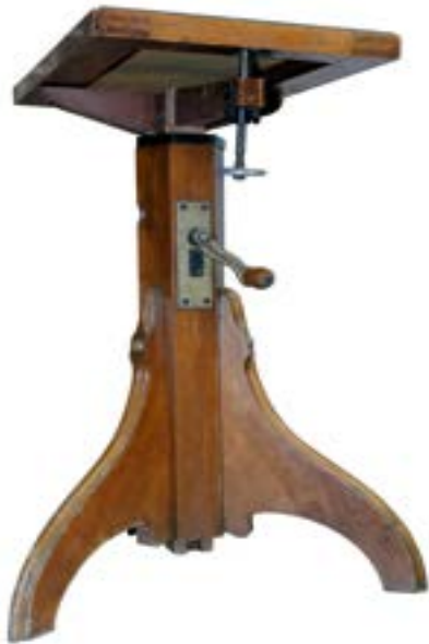
Experimentiertisch nach Pohl neigbar mit Schraube höhenverstellbar mit Kurbel [Robert Wichard Pohl, 1884 – 1976]
