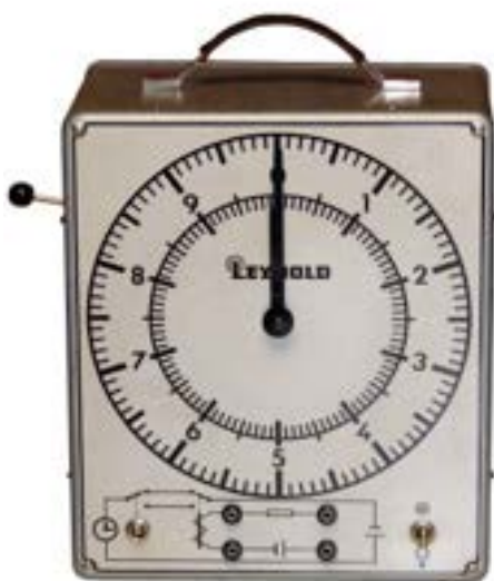
Große elektrische Stoppuhr Type: Leybold No. 313 04/570
