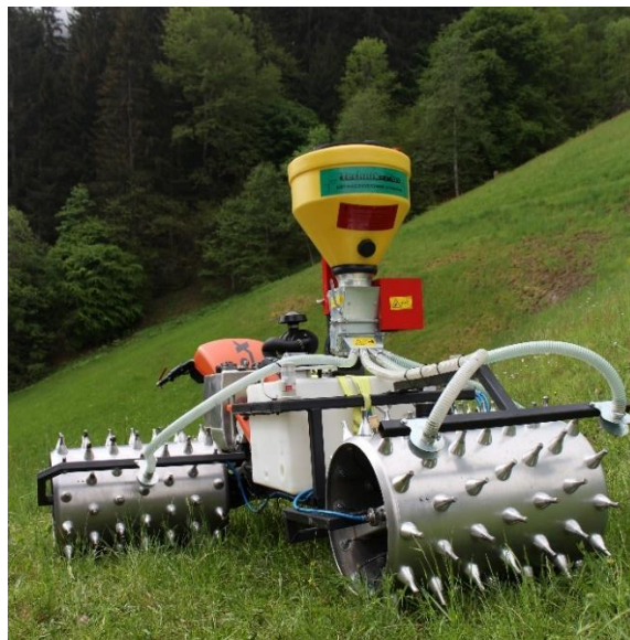
Bild 1: Applikation von Melocont™-Dispersionsformulierungen mit der MMexit. Die MMexit ist ein Anbaugerät an den IbeX Motormäher von der Firma TerraTec, welcher zur Bekämpfung von Engerlingen im Steilhang eingesetzt wird (© BIPESCO).
