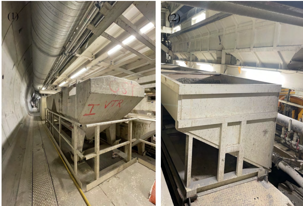
Abbildung 20: Zement (1) - und Perlkiesbehälter (2) an der TBM
