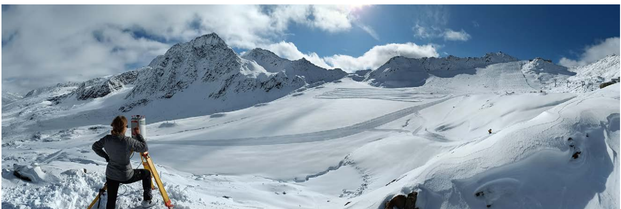
Hannah Tussetschläger (ehemals Institut für Geographie) bei der Vermessung der Oberfläche des Hochjochferners (Ötztaler Alpen) mittels eines mobilen terrestrischen Laserscanners.
