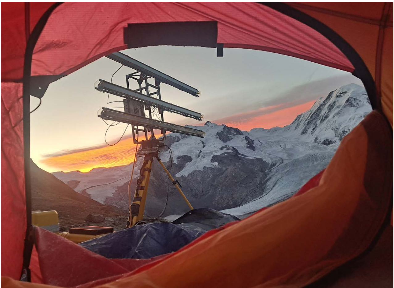
Morgendlicher Blick aus dem Zelt auf ein Radarinterferometer zur Messung der Fließgeschwindigkeit des Grenzglaciers in der Monte Rosa Gruppe (Walliser Alpen, Schweiz).
