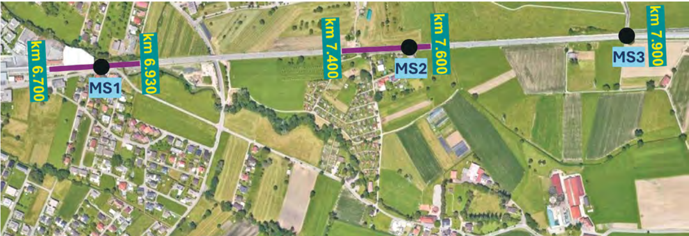
Bild 3: Messstellen an der Strecke Lustenau-Lauterach mit Schwellensohlen (MS1 und MS2) und ohne Schwellensohlen (MS3)
