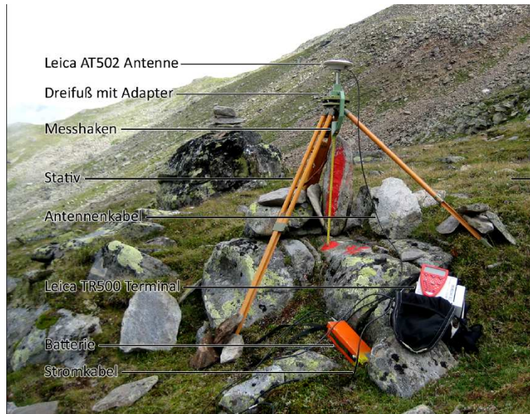
Abbildung 3.1: Messaufbau einer DGPS Referenzstation (Niederwald, 2008).
