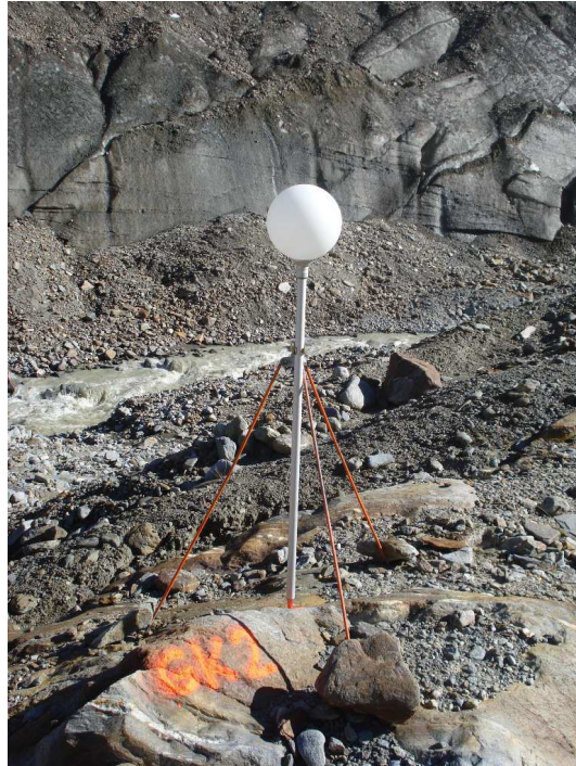
Abbildung 2.20: Passkugel \varnothing 20 cm auf Prismenstab, gestützt durch Spinne.
