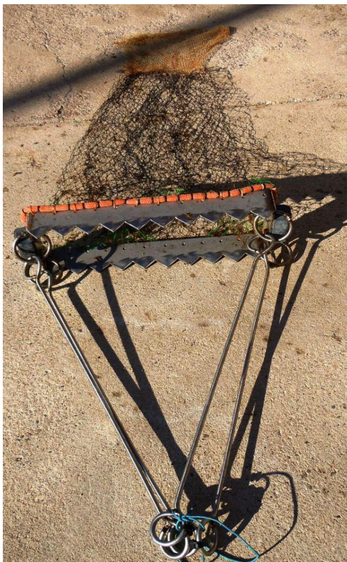
Abb.: Dredge 1: Maschenweite oben: 40mm, Maschenweite unten: 10mm, Breite der Öffnung: 60cm; 2x verwendet für 10min in 40-50m Tiefe
