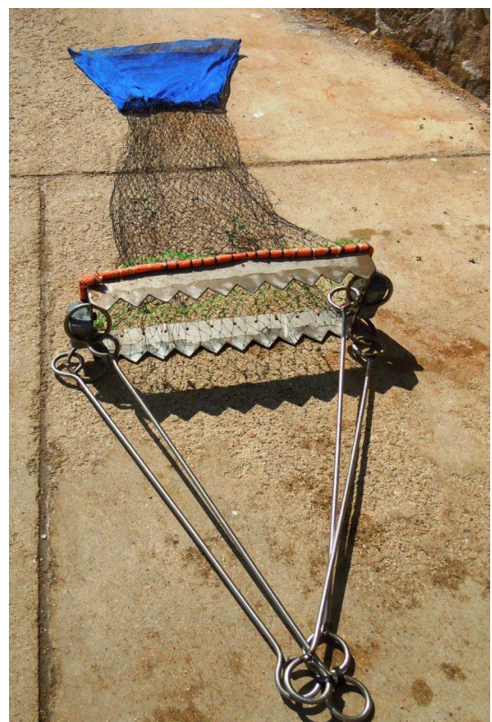
Abb.: Dredge 2 mit neuem „Unternetz“: Maschenweite: oben 40mm, unten 5mm; Breite der Öffnung: 60cm; 1x verwendet für Molluskengruppe für 15min in ca. 54m Tiefe
