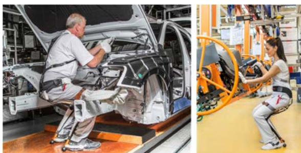
Abbildung 4: Pilotarbeitsplätze (links: Verkabelung Motorraum, rechts: Cockpitvormontage)
