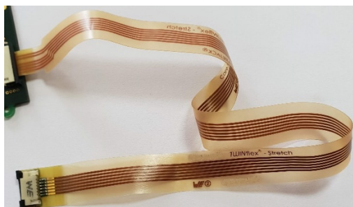
Abbildung 5: Elastische Leiterplatte (TWINflex Stretch)
