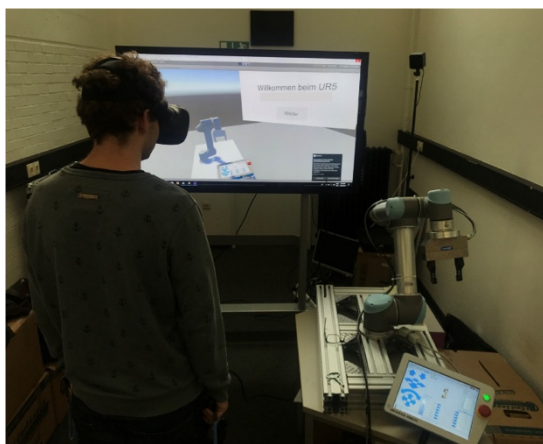
Abbildung 2: Digitaler Zwilling: realer und digitaler CoBot bewegen sich synchron in Echtzeit [Zim17]
