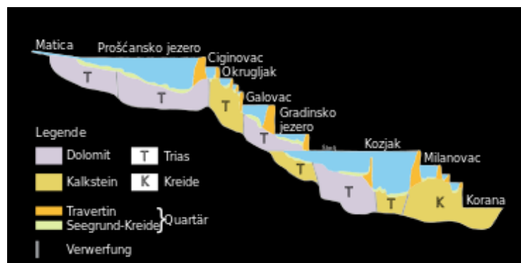
Abbildung 19: Hydrogeologisches Profil der Plitvicer Seen.
