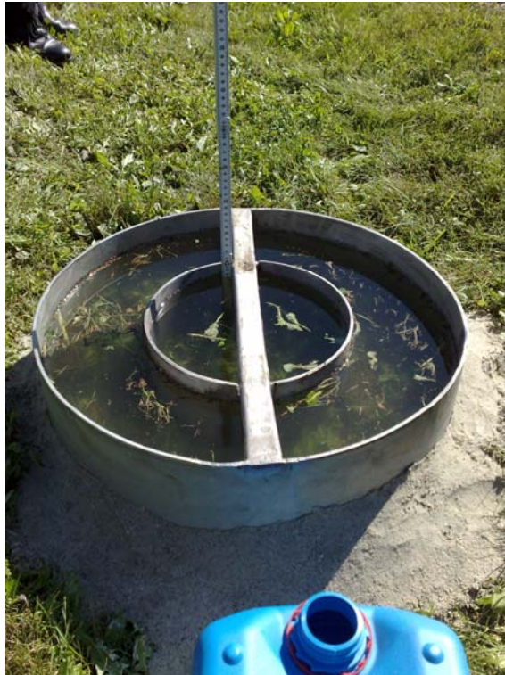
Abbildung 18: Bestimmung des k_f -Wertes mittels Doppelring-Infiltrometer
