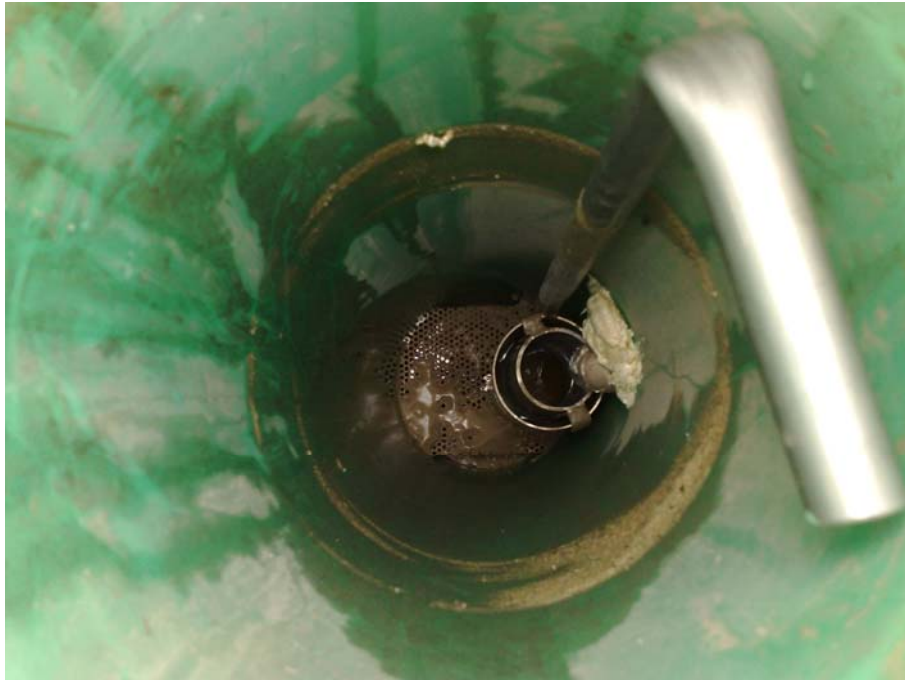
Abbildung 57: Einschwemmung von Bodenmaterial in das Probegefäß
