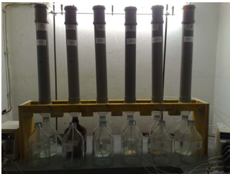
Abbildung 35: Versuchsaufbau zum Schwermetallrückhalt (rechts schematische Darstellung)
