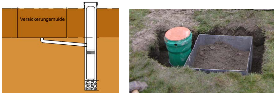
Abbildung 56: Aufbau zur Sammlung des Sickerwassers
