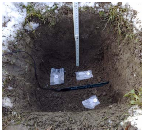
Abbildung 20: Einbau der Sensoren Winter 2008/2009 (16.12.2008)
