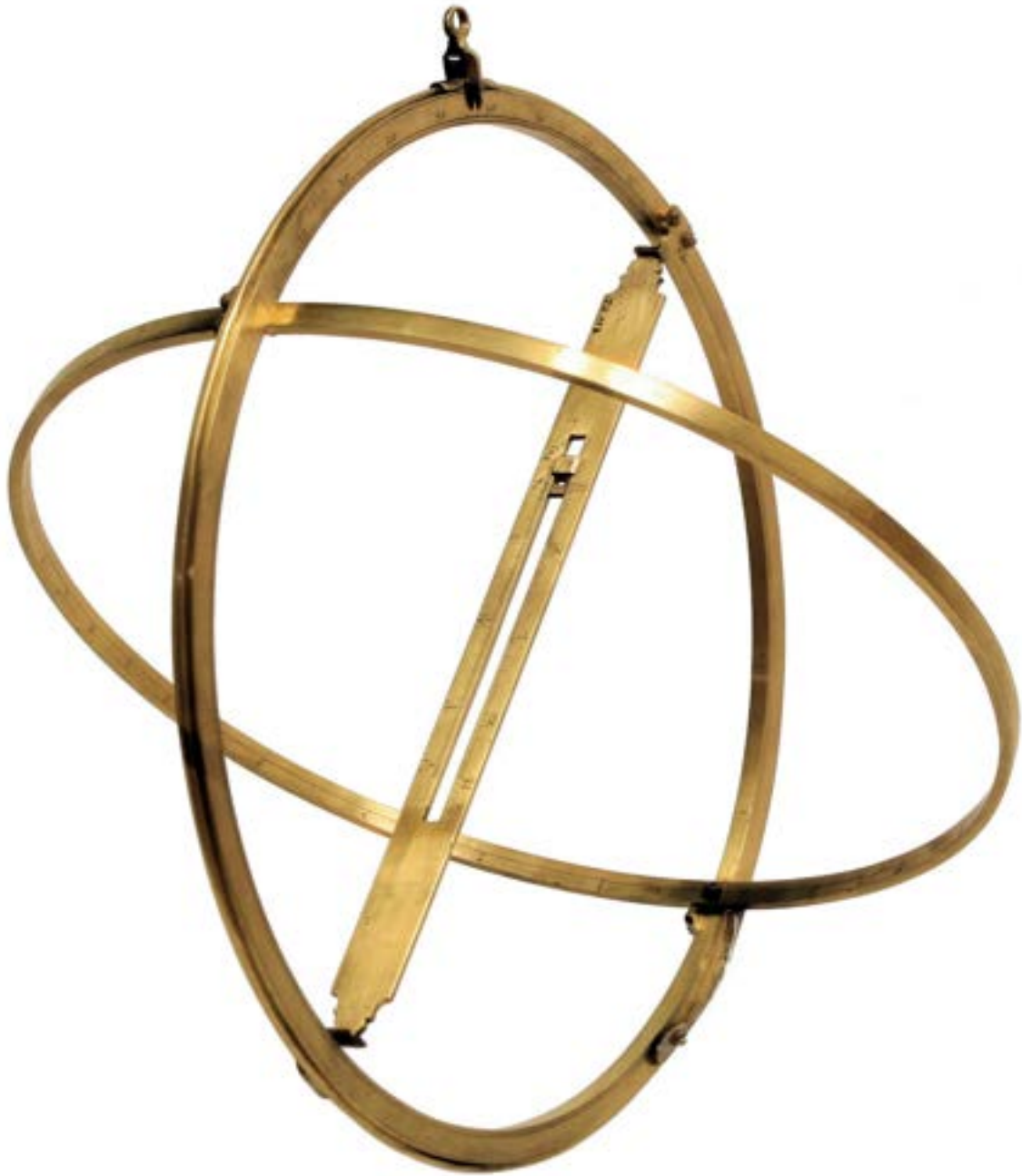
Großer Universal-Sonnenring äquatoriale Ring-Sonnenuhr / Durchmesser 25.7 cm Peter Anich ~1756 Inv. No.: K 4a [K 11a, S 8-19a, Z 8-20] im Tiroler Landesmuseum-Zeughaus inventarisiert unter TS 117 und AK/U/366
