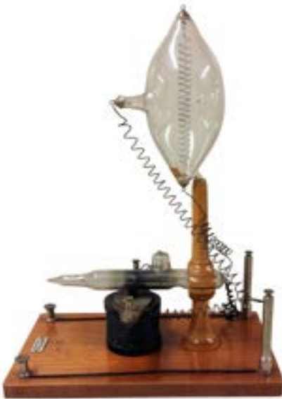
Lampe nach McFarlan Moore mit Gasentladungs-Röhre und Wagner's Hammer [Daniel McFarlan Moore, 1869 – 1936] [Johann Philipp Wagner, 1799 - 1879]
