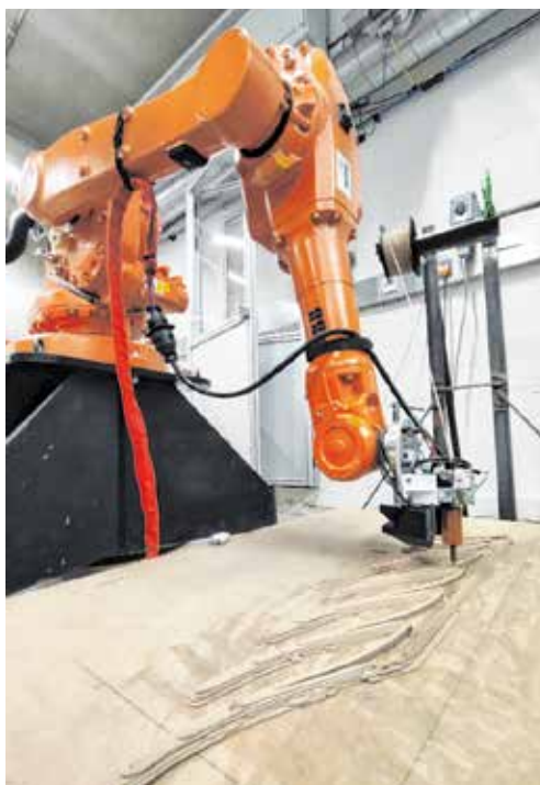
Mit einem computergestützten 3D-Verfahren werden die Platten mit Material aus Myzel, Altkleidern und Sägemehl gefertigt. Foto: Natalia Piorecka
