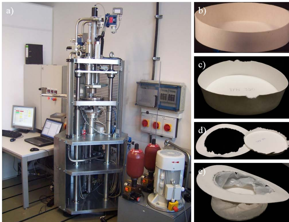
Abbildung 3.2: a) Kartontiefziehversuchsstand und b) einwandfreie sowie c) - e) fehlerhafte Ziehteile
