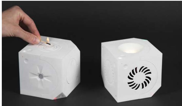
Abbildung 4.3: „Hitze wird in Licht umgewandelt“ – Ein Wärmesensor im Sensorwürfel reagiert auf das ent-zündete Streichholz, kommuniziert dies drahtlos zum Aktuatorwürfel und die Power-LED leuchtet
