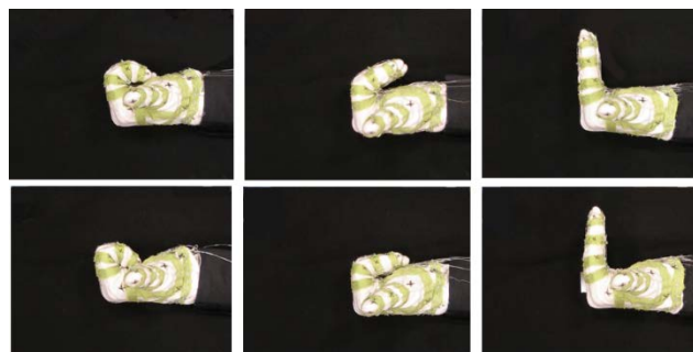
Abbildung 6.1: Fingerflexion mit verschiedenen Gelenken durch den Muskelhandschuh (obere Reihe) und ohne Unterstützung (untere Reihe) im Vergleich
