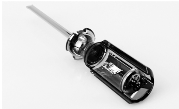
Abbildung 3.3: 3D-Entwurf des Harvesting- und Übertragungssystems im Schraubendrehergriff
