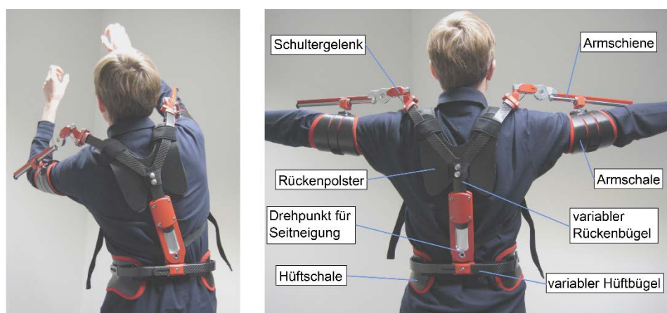
Abbildung 3.6: optimiertes Funktionsmuster mit adaptierbarer Passform
