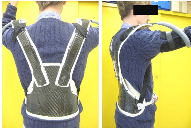
Abbildung 3.5: Funktionsmuster aus Carbon-Prepreg
