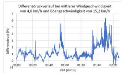
Abbildung 4.10: Maximaler bzw. minimaler Differenzdruck an der Westseite und an der Ostseite bei einer Böe mit 15 \frac{km}{h}
